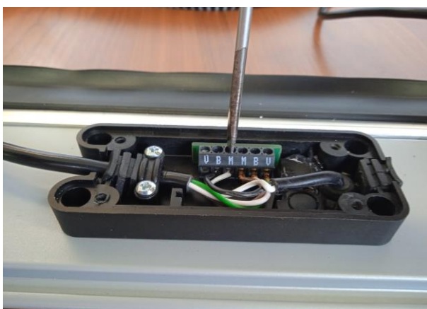
33. Podpinamy kable pod wejścia oznaczone w puszcze symbolem ,B, i ,M,. (nie ma znaczenia który kolor pod które gniazdo)
