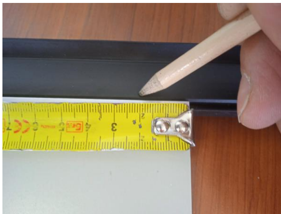
14. Z drugiej strony listwy dolnej odmierzamy 2 cm od końca listwy dolnej i zaznaczamy na listwie rezystancyjnej.
