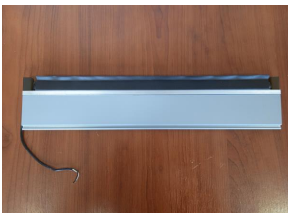
23. Prawidłowo zamontowana listwa rezystancyjna z buforami.
