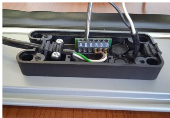
32. Popuszczamy śrubki w wejściach oznaczonych w puszcze symbolem ,B, i ,M,
