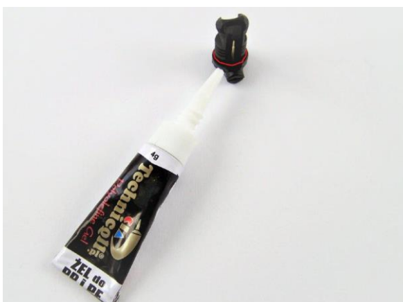
17. Na odtłuszczone miejsce nakładamy cienką warstwę żelu. Miejsce pokazane na czerwono.
