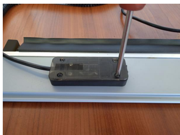
34. Zamykamy puszkę przykręcając ją 4 wkrętami.
