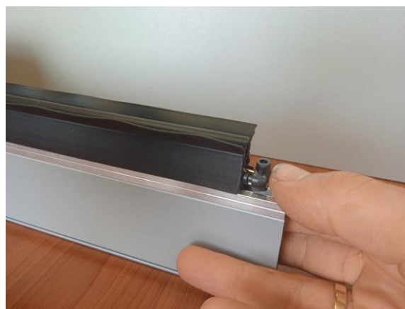
18. W pokazany sposób wsuwamy wtyczkę z rezystorem. (Trzeba to wsunąć szybko gdyż żel zaczyna szybko kleić).
