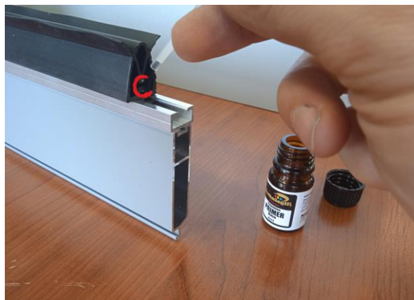
16. Odtłuszczamy listwę rezystancyjną w miejscu zaznaczonym na czerwono. Odtłuszczamy także wtyczkę z rezystorem.
